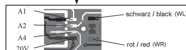
Funktionsdecoder-Anschluß am Beispiel des Beiwagen VT98 # 40681:
