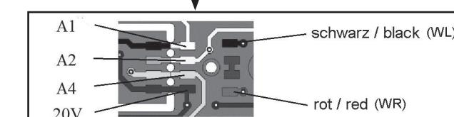
Funktionsdecoder-Anschluß am Beispiel des Beiwagen VT98 # 40681:
