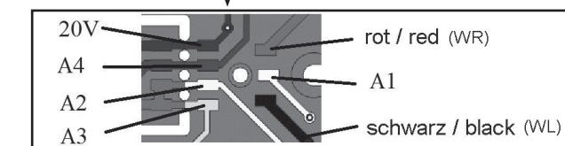
Funktionsdecoder-Anschluß am Beispiel des Beiwagen VT98 # 40680:
