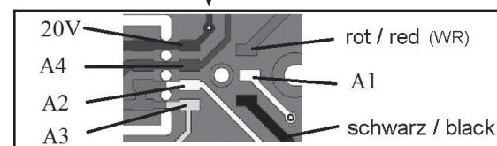
Funktionsdecoder-Anschluß am Beispiel des Beiwagen VT98 # 40680:
